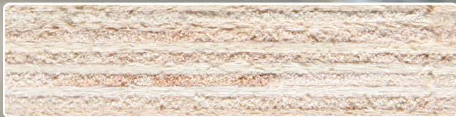
刀缝壁木质纤维和碳化层对比
